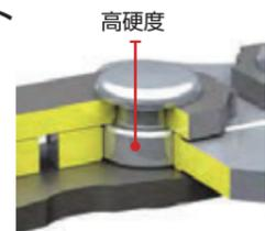
硬度、耐摩耗性を強化したリベットにより摩耗とチェーンの伸びを抑制。張り調整の手間を削減します。
