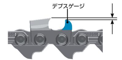
カッターが木に食い込む深さを調整する役目を持っています。この高さは、デブスゲージの上先端と、カッター上刃の上端間の距離です。この高さは、カッターのタイプごとに決まっています。
